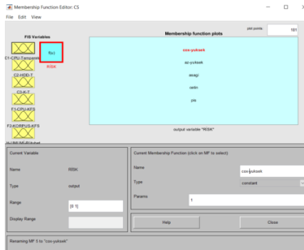
Şəkil 4. R ( RISK ) – çıxış linqvistik dəyişəni üçün mənsubiyyət funksiyasının təyini Giriş və çıxış dəyişənlərinin mənsubiyyət funksiyası seçildikdən qaydalar bazasının yaradılması tələb olunur [12]. Qaydalar bazası Edit-Rule əmri seçilir (şəkil 5).
