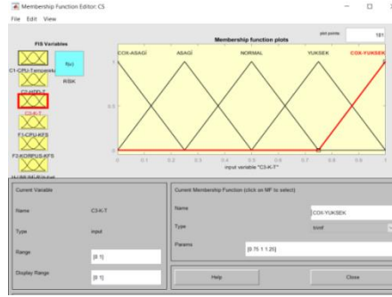
Şəkil 3. C2, C3 – giriş linqvistik dəyişənləri üçün mənsubiyyət funksiyasının təyini R ( RISK ) – çıxış linqvistik dəyişəni üçün mənsubiyyət funksiyasının tipi \text{trimf} seçilir (şəkil 4): \text{trimf}(5) = \{\text{pis}, \text{çətin}, \text{aşağı}, \text{az yüksək}, \text{çox yüksək}\}.
